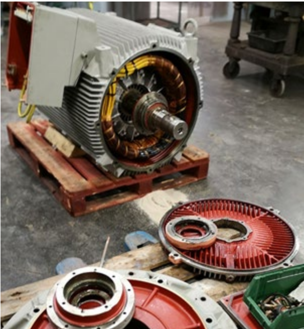
Démontage, expertise et intervention en atelier
